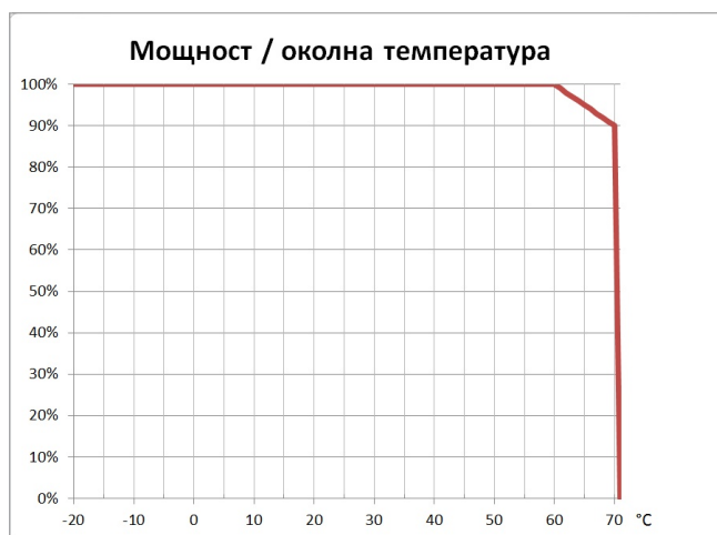
фиг. 4. Зависимост на максималната мощност от околната температура
