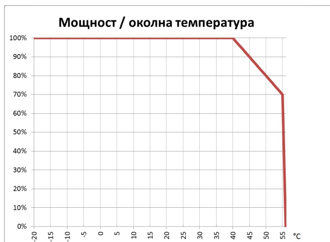
фиг. 2. Зависимост на максималната мощност от околната температура
